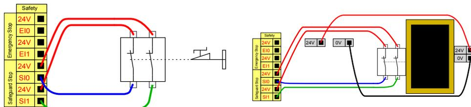
Este ejemplo ilustra un interruptor de puerta como un dispositivo de protección básico donde el robot se detiene cuando la puerta se abre.
