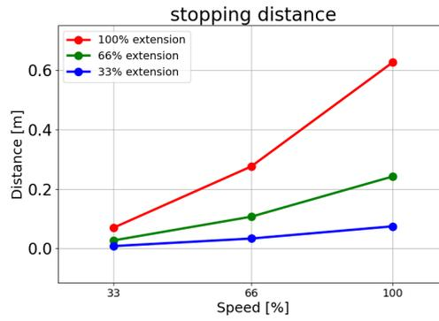
Distancia de parada en metros para una carga útil ampliada de 25 kg
