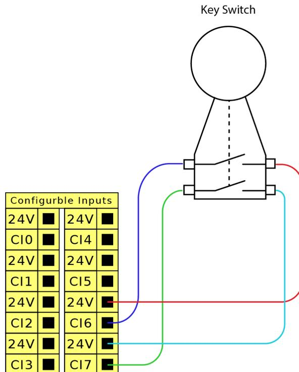
**Para configurar las entradas de seguridad conectadas**
