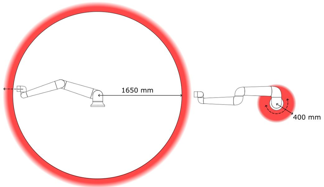
*Debido a las propiedades físicas del brazo robótico, determinadas zonas de espacio de trabajo requieren atención en relación con los peligros de pinzamiento. Se define un área (izquierda) para movimientos radiales cuando la articulación de la muñeca 1 está al menos a 1650 mm de la base del robot. La otra área (derecha) está a 400 mm de la base del robot al moverse tangencialmente.*
