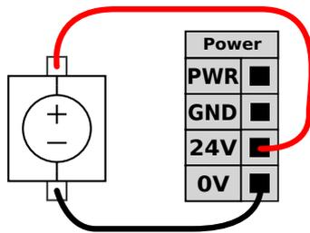
En este ejemplo, la configuración utiliza una fuente de alimentación externa para obtener más corriente.
