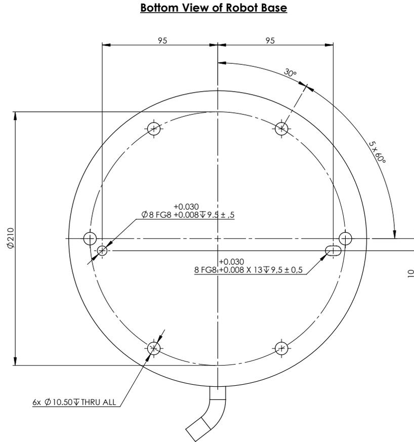
*Dimensiones y patrón de orificios para montar el robot.*
