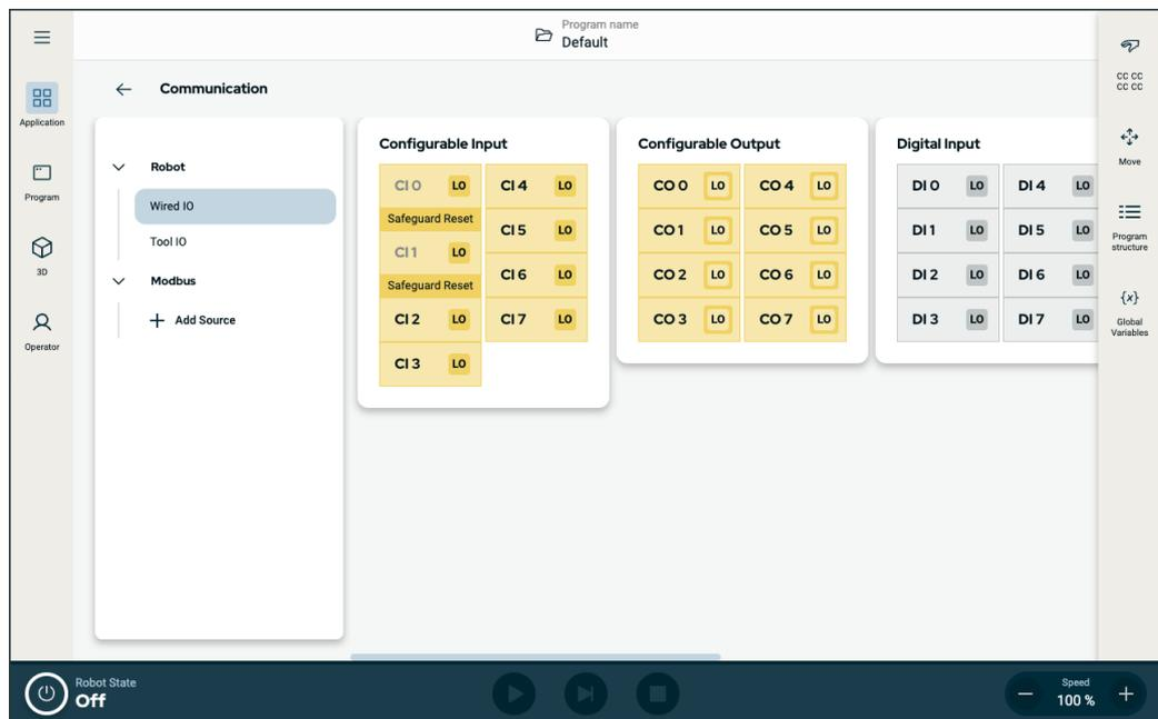
Figura 1.2: Pantalla de comunicación que muestra las E/S.
