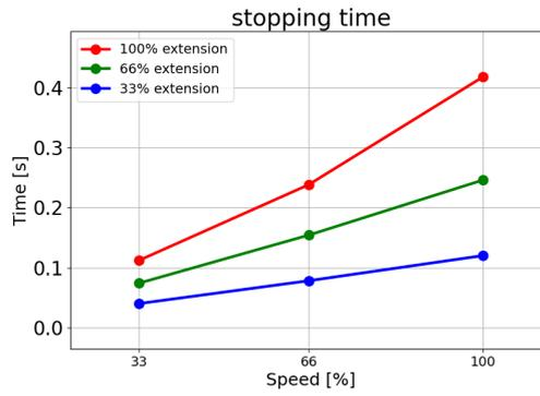
Tiempo de parada en segundos para una carga útil ampliada de 25 kg.
