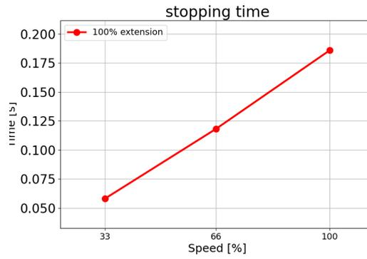
Tiempo de parada en segundos para una carga útil ampliada de 25 kg
