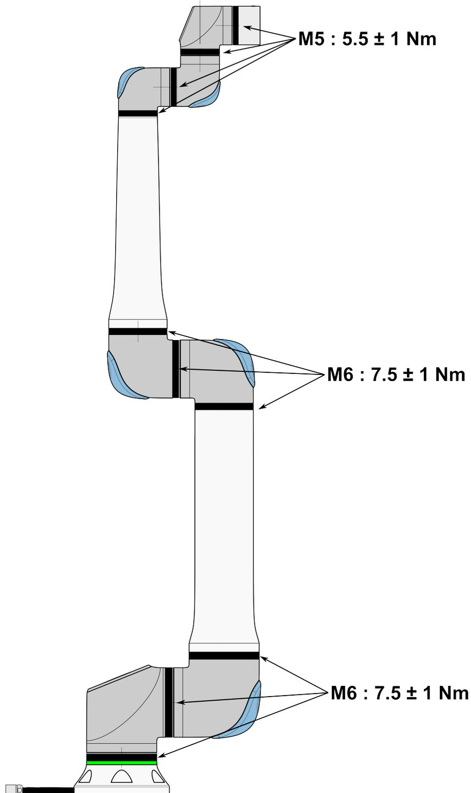
**Plan de inspección del brazo robótico**
