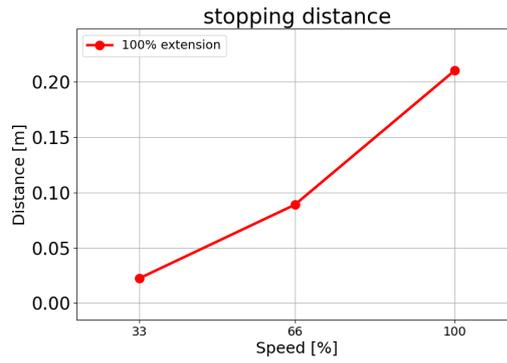
Distancia de parada en metros para una carga útil ampliada de 25 kg
